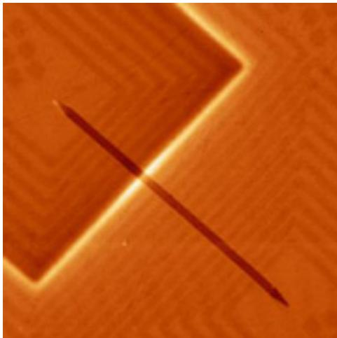
Пока устройство нельзя назвать полноценной памятью: перед нами единичный железно-никелевый нанопровод (тёмно-коричневый на снимке), служащий для проверки основных принципов (фото IBM).
